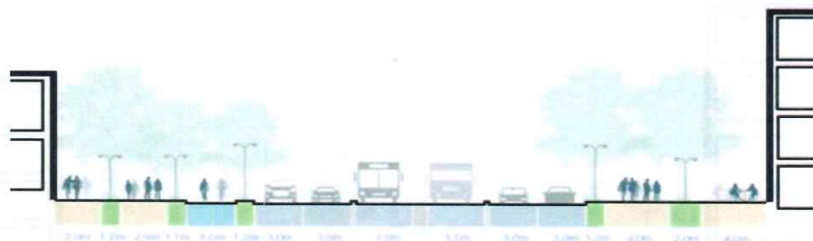
Sección propuesta típica sin estación entre Calle 100 y Calle 200
